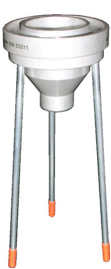
DIN 53211 - 4 mm cup with tripod
